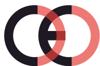
Marcatura CE contraffatta (troppo vicino)
